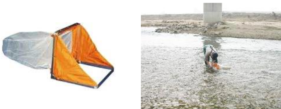
<그림 4> 서버넷(Surber net) 및 이를 이용한 채집모습
